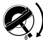
Tankverschluss mit Klappflügel (Bajonettverschluss) korrekt einsetzen, bis zum Anschlag drehen und den Bügel zuklappen.
