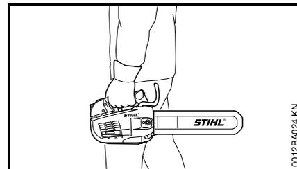
Motorsäge nur am Bedienungsgriff tragen – heißer Schalldämpfer vom Körper weg, Führungsschiene nach hinten. Heiße Maschinenteile, insbesondere die Schalldämpferoberfläche, nicht berühren – Verbrennungsgefahr!
