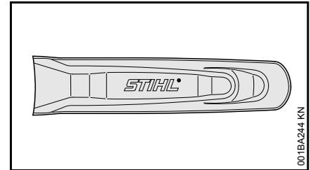
Im Lieferumfang ist ein zur Schneidgarnitur passender Kettenschutz enthalten.
