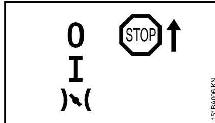
**Stop 0** – Motor aus – Zündung ist ausgeschaltet
