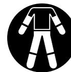
Die Kleidung muss zweckmäßig sein und darf nicht behindern. Eng anliegende Kleidung mit **Schnittschutzeinlage** für Füße, Beine, Hände und Unterarme tragen – Kombianzug, keinen Arbeitsmantel.
