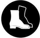
**Schutzstiefel** tragen, die für die Klettertechnik geeignet sind – mit Schnitenschutz, griffiger Sohle und Stahlkappe.
