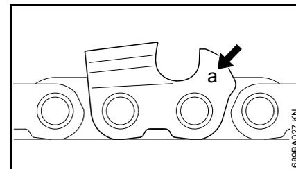
Die Kennzeichnung (a) der Kettenteilung ist im Bereich des Tiefenbegrenzers jedes Schneidezahnes eingeprägt.
