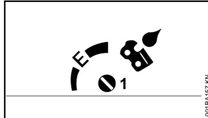
Mit dem Einstellbolzen (1) (an der Unterseite der Maschine) kann die Ölfördermenge je nach Bedarf reguliert werden.
