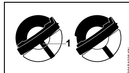
links: Unterteil des Tankverschlusses verdreht – innenliegende Markierung (1) fluchtet mit der äußeren Markierung
