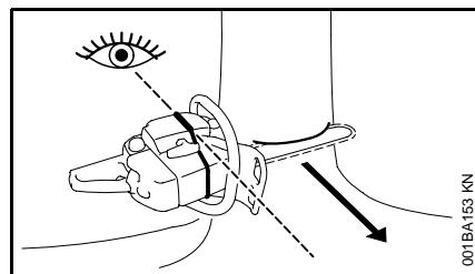
Met behulp van de vellijs op de kap en het ventilatorhuis van de motorzaag kan tijdens het zagen van de valkerf de velrichting worden gecontroleerd.
