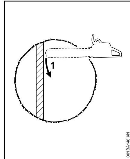
Nagetrokken waaiersnede (meer-sectoren-snede) aanbrengen, als de stamdiameter groter is dan de zaaglengte van de motorzaag.
