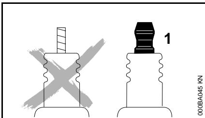
**!** Con una candela con dado di attacco separato (1), avvitare assolutamente il dado sul filetto e serrarlo forte – la formazione di scintille può creare il pericolo d'incendio!
