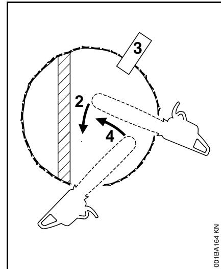
2. während des Nachsetzens zum nächsten Schnitt Führungsschiene voll im Schnitt lassen, um unebenen Fällschnitt zu vermeiden – wieder Krallenanschlag ansetzen usw.
