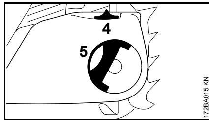
Applicando il coperchio del rochetto, i denti della ruota dentata e del disco tendicatena devono fare presa fra loro, ev.
