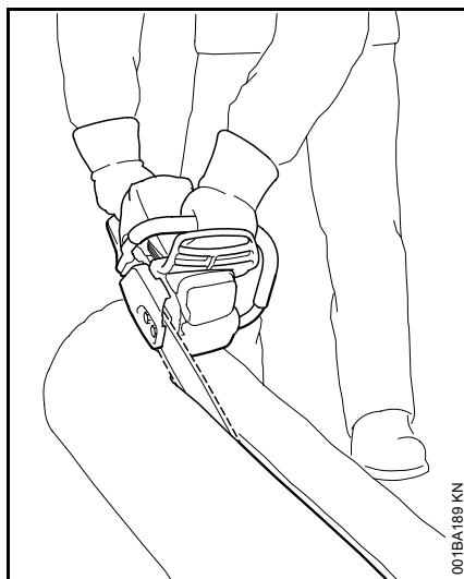
Tecnica di taglio senza l'uso dell'artiglio – pericolo di trascinamento in avanti – applicare la spranga ad un angolo più piatto possibile – procedere con particolare prudenza – notevole **pericolo di rimbalzo!**
