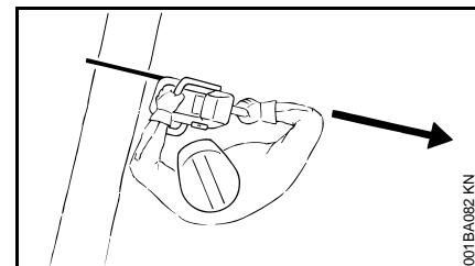
Non esporre nessuna parte del corpo nel prolungamento del **raggio d'azione** della catena.
