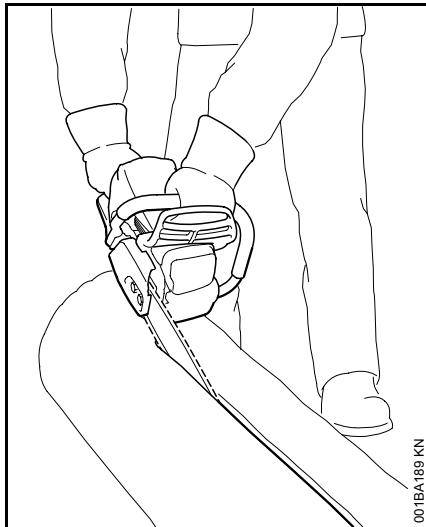
Sägetechnik ohne Benutzung des Krallenanschlages – Gefahr des Hineinziehens – Führungsschiene in möglichst flachem Winkel ansetzen – besonders vorsichtig vorgehen – erhöhte **Rückschlaggefahr!**
