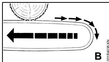
Als tijdens onderhands zagen de zaagketting klemt of een vast voorwerp in het hout raakt, kan de motorzaag in de richting van de motorzaaggebruiker terug worden gestoten – **om dit te voorkomen:**
