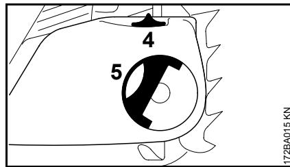
Beim Ansetzen des Kettenraddeckels müssen die Zähne von Spannrad und Spannscheibe ineinander greifen, ggf.
