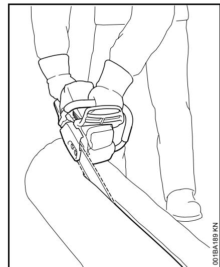
Zaagtechniek zonder gebruik te maken van de kam – kans dat de zaag in het hout wordt getrokken – het zaagblad onder een zo vlak mogelijke hoek aanzetten – verhoogde **kans op terugslag!**
