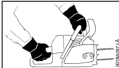
Toujours tenir fermement la tronçonneuse **à deux mains** : main droite sur la poignée arrière – ceci est également valable pour les gauchers. Pour pouvoir guider la machine en toute sécurité, empoigner fermement la poignée tubulaire et la poignée de commande en les entourant avec les pouces.
