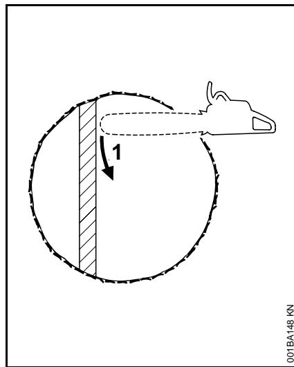
Nachgezogenen Fächerschnitt (Mehrsektorenschnitt) ausführen, wenn der Stammdurchmesser größer als die Schnittlänge der Motorsäge ist.
