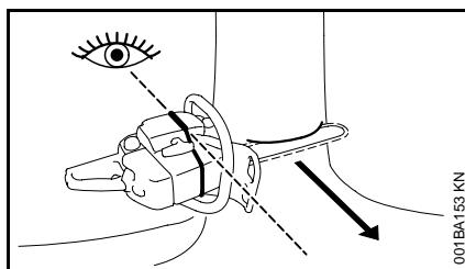
La nervure de visée prévue sur le capot et sur le carter de ventilateur de la tronçonneuse aide à contrôler la direction de chute en exécutant l'entaille d'abattage.
