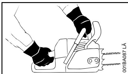
**Motorsäge immer mit beiden Händen festhalten:** Rechte Hand am hinteren Handgriff – auch bei Linkshändern. Zur sicheren Führung Griffrohr und Handgriff mit den Daumen fest umfassen.
