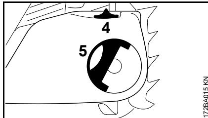
Bij het aanbrengen van het kettingtandwieldeksel moeten de tanden van het spanwiel en de spanring in elkaar vallen, zonodig
