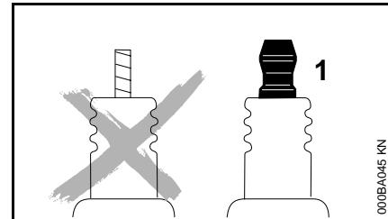
**⚠ Bei einer Zündkerze mit separater Anschlussmutter (1) unbedingt die Anschlussmutter auf das Gewinde drehen und **fest** anziehen – durch Funkenbildung **Brandgefahr!****
