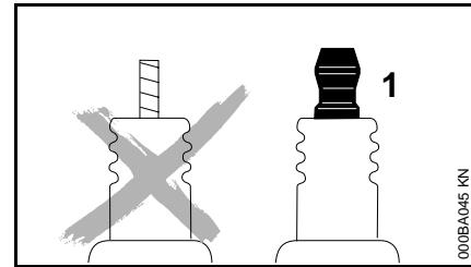
**!** Bij een bougie met aparte aansluitmoer (1) de aansluitmoer **beslist vastdraaien** – brandgevaar door vonkvorming!
