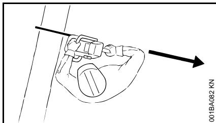
Geen lichaamsdelen in het verlengde **zwenkbereik** van de zaagketting houden.
