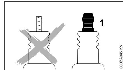
**!** Sur une bougie avec écrou de bougie séparé (1), il faut impérativement visser l'écrou sur le filetage et le serrer **fermement** – sinon, un jaillissement d'étincelles pourrait se produire **risque d'incendie !**
