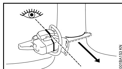
Mit Hilfe der Fällleiste an Haube und Lüftergehäuse der Motorsäge kann beim Schneiden des Fallkerbes die Fällrichtung kontrolliert werden.
