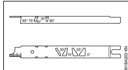
STIHL vijlkaliber (speciaal toebehoren, zie tabel "Slijpgereedschappen") – een universeel gereedschap voor de controle van de aanscherp- en voorsnijvlakhoek, afstand dieptebegrenzers, tandlengte, groefdiepte en voor het reinigen van de groef en de olietoevoerboringen.
