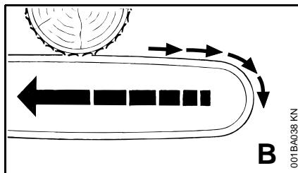
Wenn beim Sägen mit der Oberseite der Führungsschiene – Rückhandschnitt – die Sägekette klemmt oder auf einen festen Gegenstand im Holz trifft, kann
