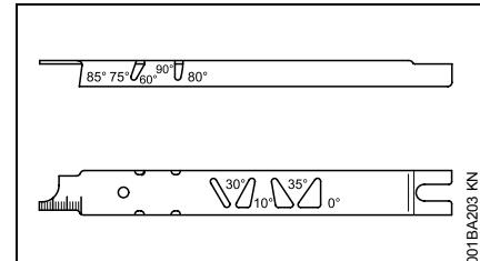
Utiliser le calibre d'affûtage STIHL (accessoire optionnel, voir le tableau « Outils d'affûtage ») – un outil universel pour contrôler l'angle d'affûtage, l'angle de front, le retrait du limiteur de profondeur, la longueur des dents et la profondeur de la rainure ainsi que pour nettoyer la rainure et les orifices d'entrée d'huile.
