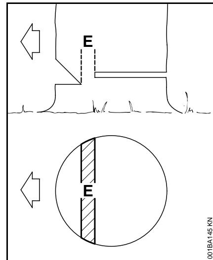
Die **Bruchleiste (E)** führt den Baum wie ein Scharnier zu Boden.
