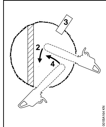
2. durante l'avanzamento verso il taglio successivo, inserire la spranga completamente nel taglio, per evitare che il taglio di abbattimento sia irregolare – piazzare di nuovo l'artiglio, e così via
