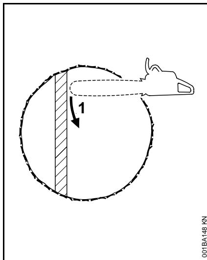
Exécuter une coupe en éventail suivie si le diamètre du tronc dépasse la longueur de coupe de la tronçonneuse.
